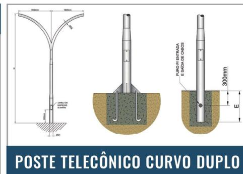
Poste Telecônico fabricado em tubos de aço soldados em seções variáveis. O dimensionamento da quantidade de seções e número de divisões varia de acordo com a altura e área vélica\*
